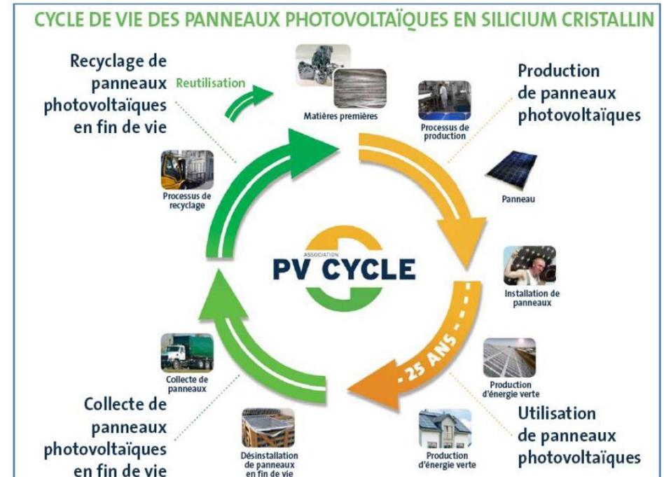
Figure 36 - Cycle de vie d'un panneau photovoltaïque en silicium cristallin
