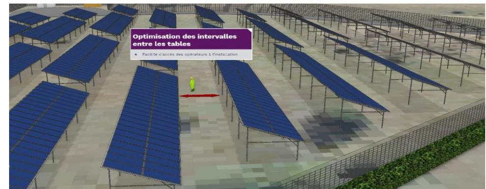
Figure 20 - Distance entre les rangées de panneaux
